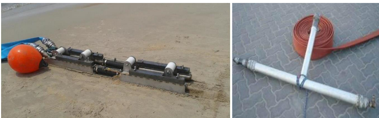
Figure 23 : « Jet sledge » de type WORM pour les eaux très peu profondes (à gauche), lance à eau d'ensouillage (à droite) (source : Orange Marine)
